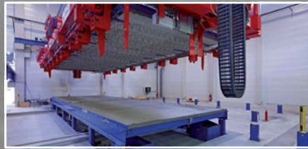
Sistemas de circulación de bandejas para la producción de prefabricados de hormigón planos
