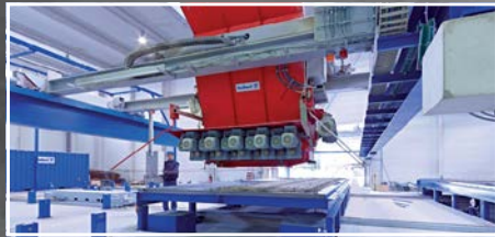
Sistemas de circulación de bandejas para la producción de prefabricados de hormigón planos
